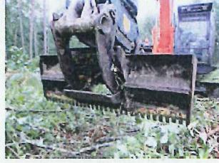
○素材生産作業に使用したグラップルに独自開発したレーキを装着した大型機械による地拵の実施により、作業効率を向上させた。
