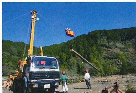
急傾斜地における架線系高性能機械を用いた集材システムとコンテナ苗造林による一貫作業システムの現地検討会デモンストラクション（自走式搬器による集材）
