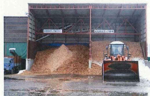
木質バイオマス利用のため、チップ化された未利用材
