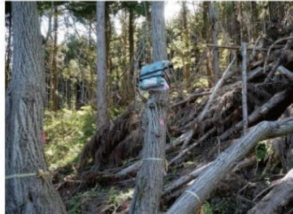
コウモリの音声モニタリングに使用した「自動超音波録音装置」
