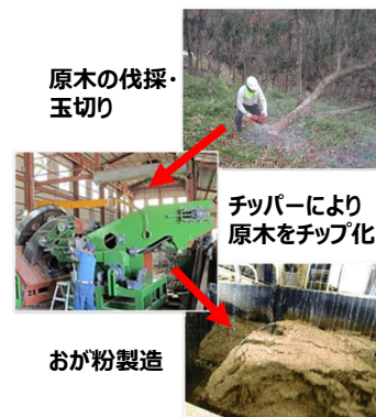
原木の伐採・玉切り チッパーにより原木をチップ化 おが粉製造
