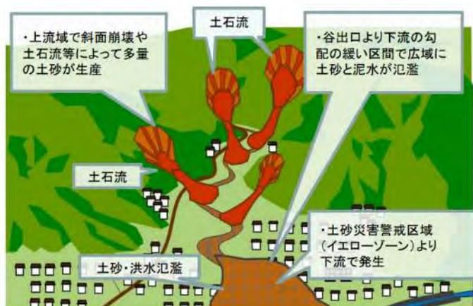
図 5.10 土砂・洪水氾濫のイメージ
