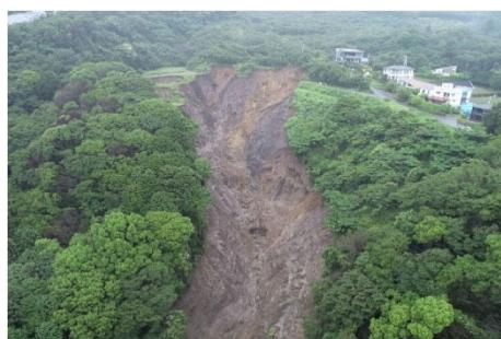
斜面地の谷を埋め、土砂が崩落した事例<sup>1)</sup>
