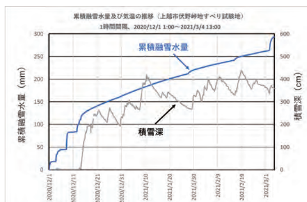
伏野峠地すべり試験地（新潟県上越市、標高570m）における融雪水量と積雪深の長期変動（2020/12/1～2021/3/4）
