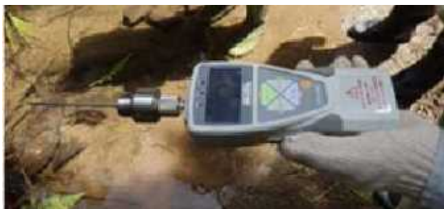
図 14 マイナスドライバーによる荷重測定機器の例（岐阜県森林研究所 HP より）
