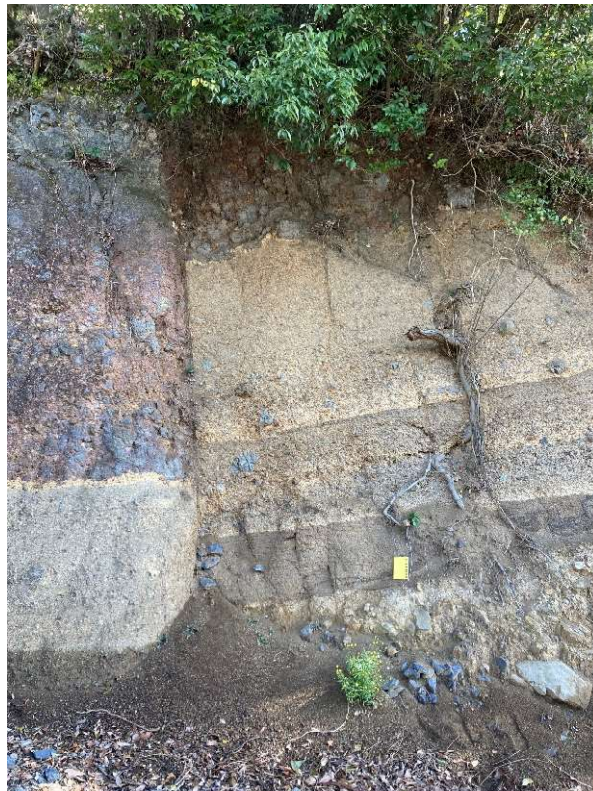
図 88 現地写真：A-7 崩壊地手前の断層の露頭と思われる箇所
