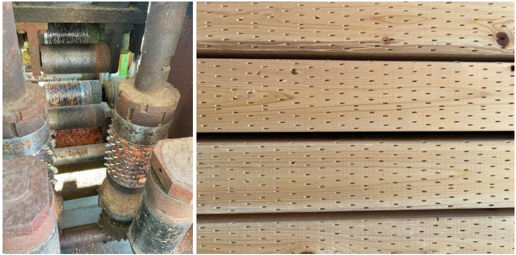
写真-2 インサイジング加工機械の内部構造（左）と加工後の木材（右）
