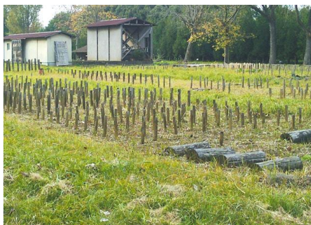
写真-8 木杭の野外試験場の状況
