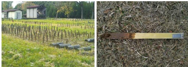
写真-8 木杭の野外試験場の状況 写真-9 29年後に確認した木杭
