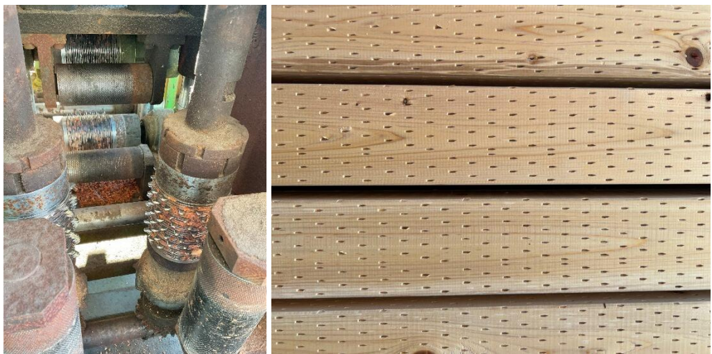
写真 4-2 インサイジング加工機械の内部構造（左）と加工後の木材（右）
