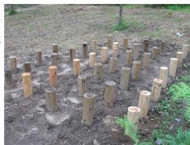
写真-10 処理材の野外杭耐朽試験
