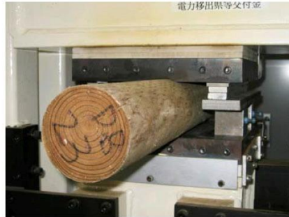
写真-7 平板プレスによる圧縮
