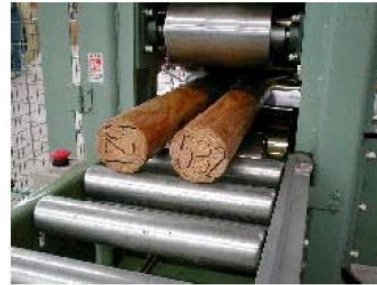
写真-5 ロール圧縮処理
