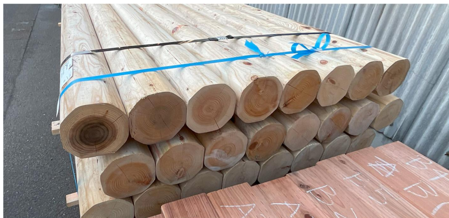
写真 4-3 圧縮処理後（加圧注入前）の木材（再掲）
