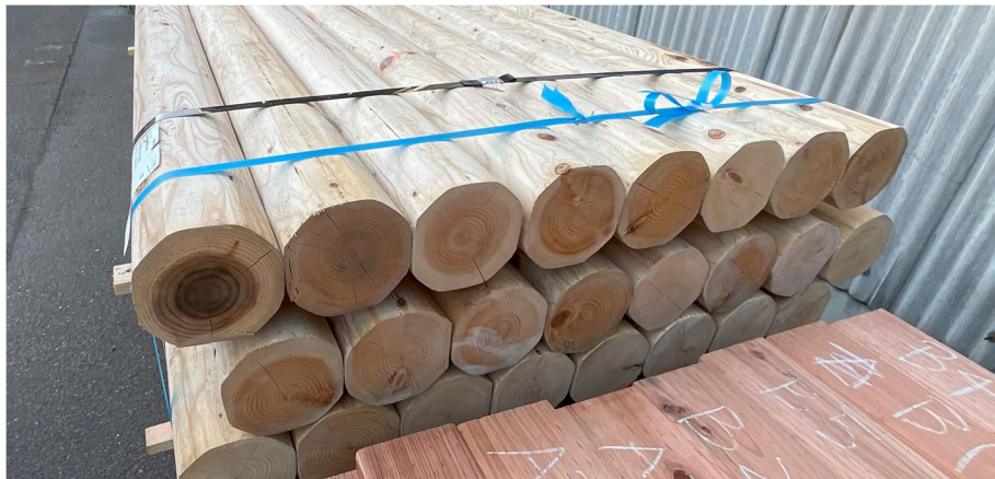
写真 3-2 圧縮処理後（加圧注入前）の木材
