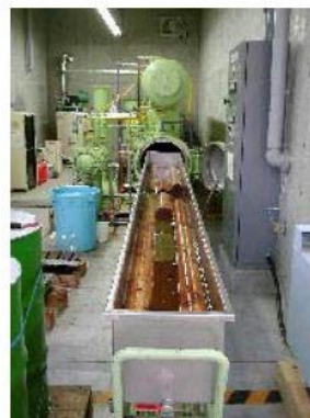
写真-1 真空含浸装置による防腐剤の含浸
