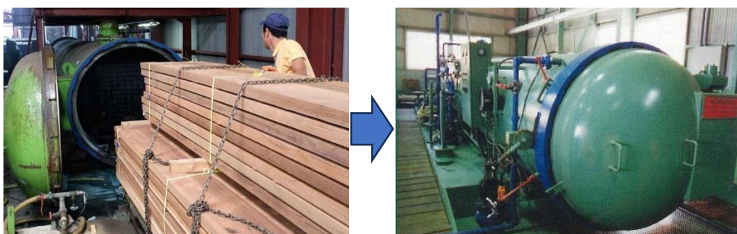
写真 3-1 加圧注入の作業（左：木材を釜に入れる 右：薬剤で浸し圧力をかける）
