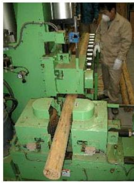
写真-6 インサイジングマシンによるインサイジング処理
