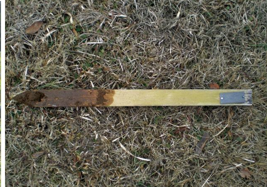
写真 3-16 29 年後に確認した杭の状況
