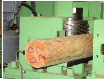
写真-6 インサイジングマシンによるインサイジング処理
