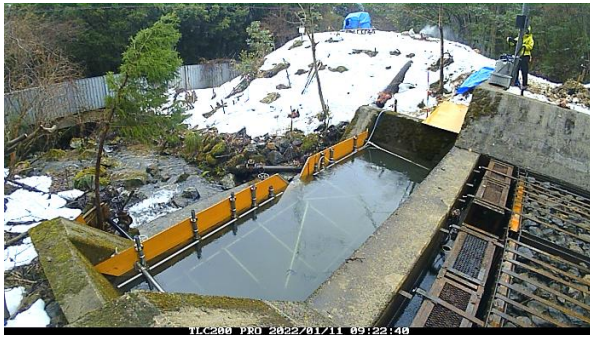
図 4.40 1月11日 9:21 沈砂池に濁質を投入。
