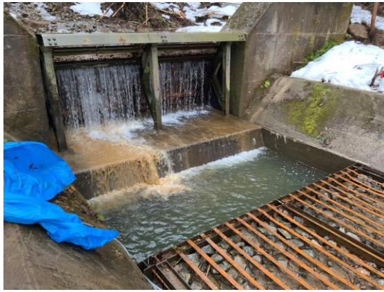
図 4.36 9:21 左:投入直後の濁質拡散状況 右:投入した濁質
