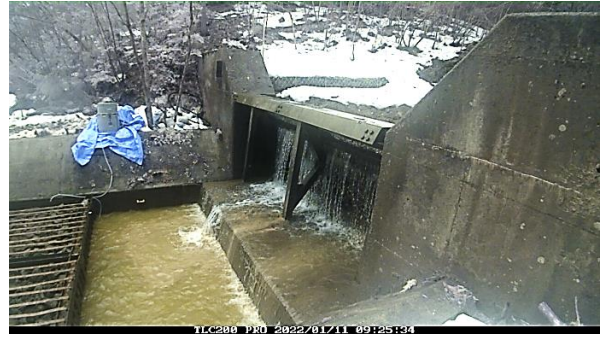
図 4.40 1月11日 9:21 沈砂池に濁質を投入。
