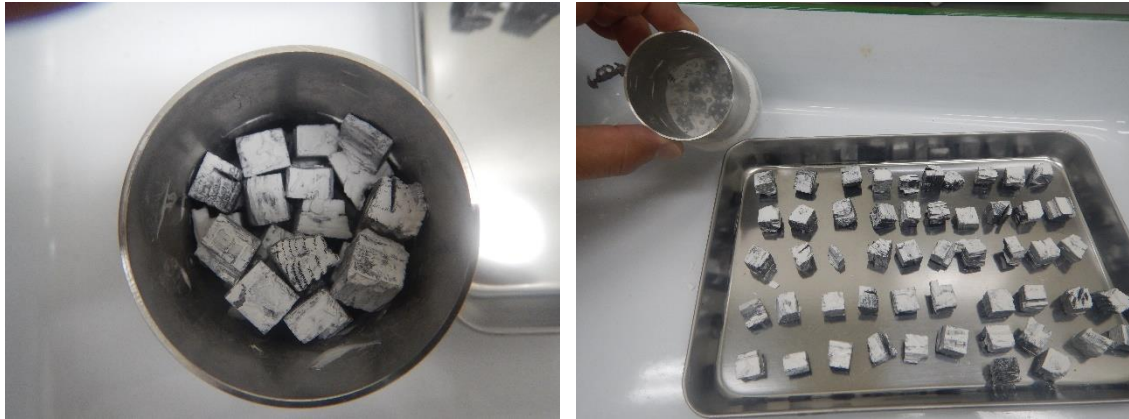
図 5.7 試料No.1 のカオリン捕捉状況
