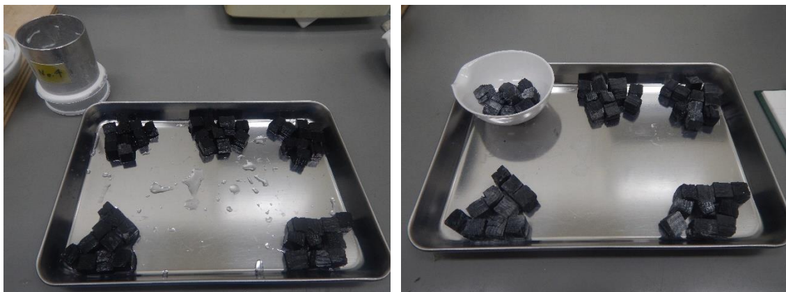
図 5.8 ろ過済木炭を洗浄後、絶乾重量を計測し、木炭に吸着されたカオリン量を計測
