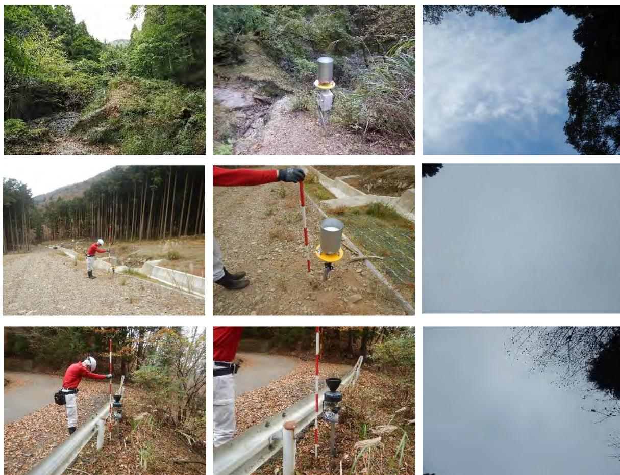
図 2.9 林外の雨量計設置状況(上:玄倉 中:猪之頭 1 下:猪之頭 2)
