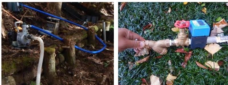
図 3.37 エンジンポンプと流量計(ストレーナ、ゲートバルブ付)
