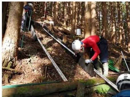
図 3.23 集水枠の設置
