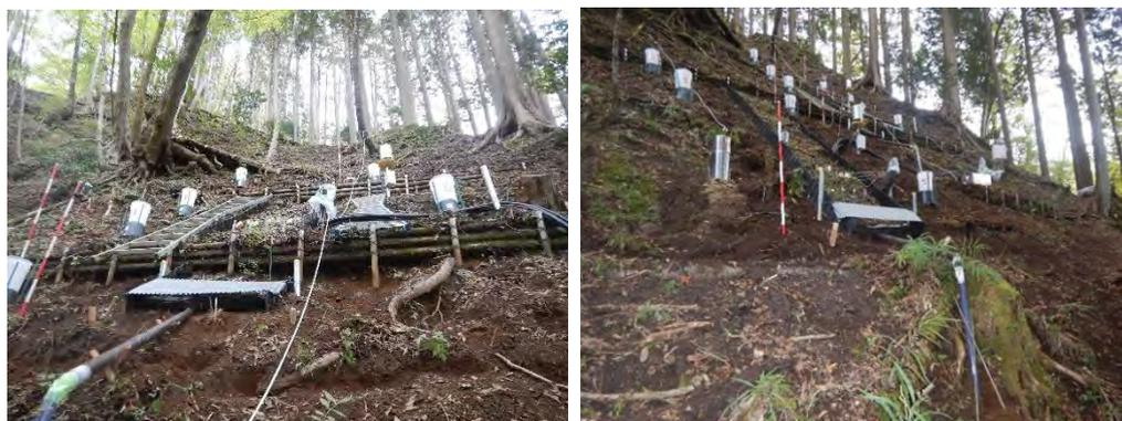
図 3.5 自然降雨試験における雨量観測状況(左:筋工有 右:筋工無)
