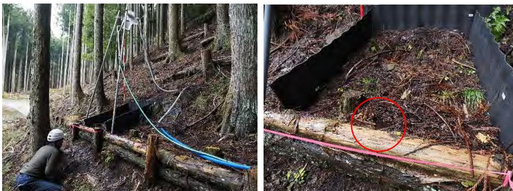
図 3.42 猪之頭 1 の筋工有における予備試験状況(左)及び集水枠内の筋工背面の湛水(右)
