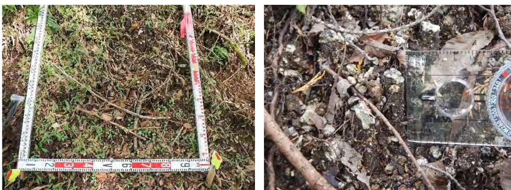
図 2.14 調査地周辺の草本層と雨滴侵食による土柱の発生状況
