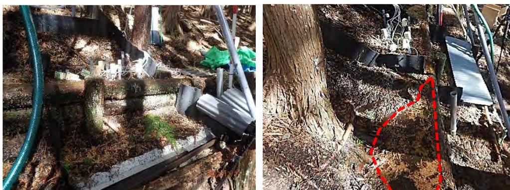
図 3.68 散水終了後のテンシオメータ状況(左)と湛水状況(右)
