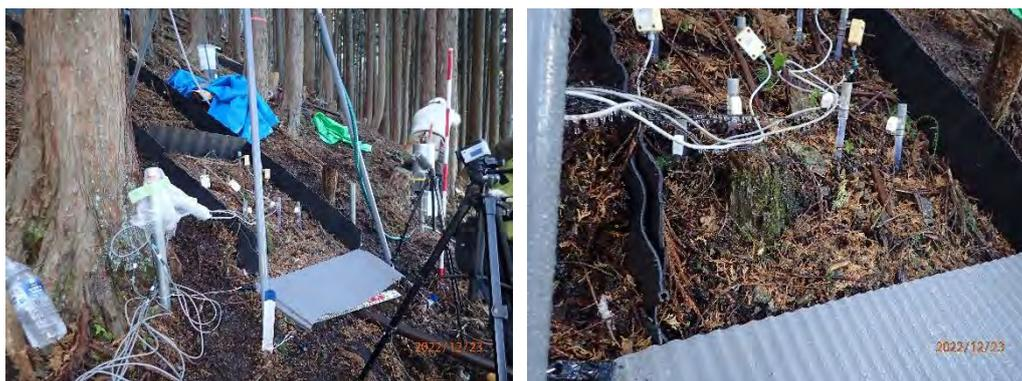
図 3.70 人工降雨試験実施状況
