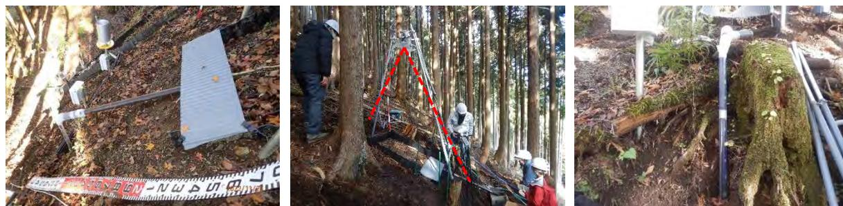
図 3.26 導水部(左)、人工降雨装置の散水範囲(中)、集水タンク(右、水位計を設置した例)
