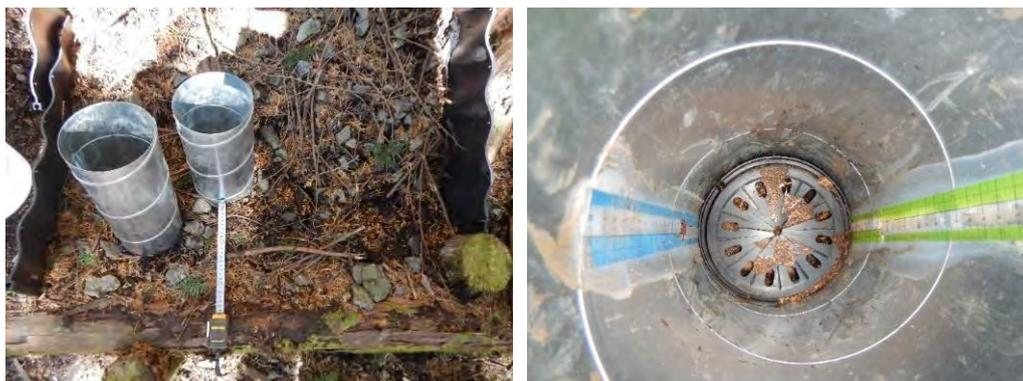
図 3.83 簡易冠水型浸透能試験 左:筋工有における配置 右:円筒内のゴム蓋の設置
