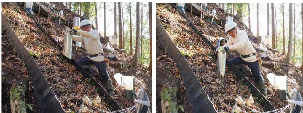
図 3.82 簡易冠水型浸透能試験 左:円筒の設置 右:円筒の埋設
