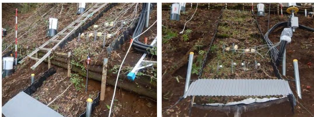
図 3.104 テンシオメータの現地設置状況(左:筋工有 右:筋工無)
