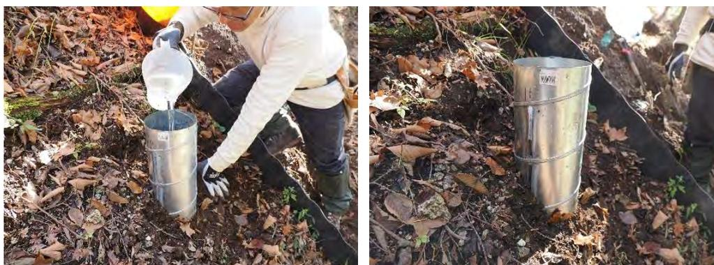
図 3.84 冠水型浸透能試験の方法 左:注水容器による注水 右:水減量と浸透時間の計測
