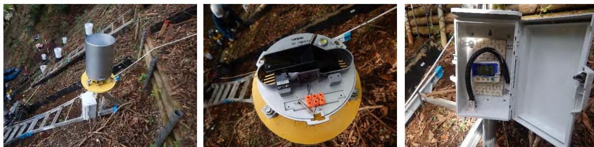
図 2.8 転倒マス型雨量計とデータ記録用のパルスロガー(写真は林内の雨量計を参考掲載)
