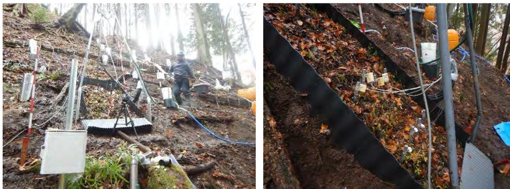
図 3.52 人工降雨試験状況(左)と散水終了直後の地表面状況(右)
