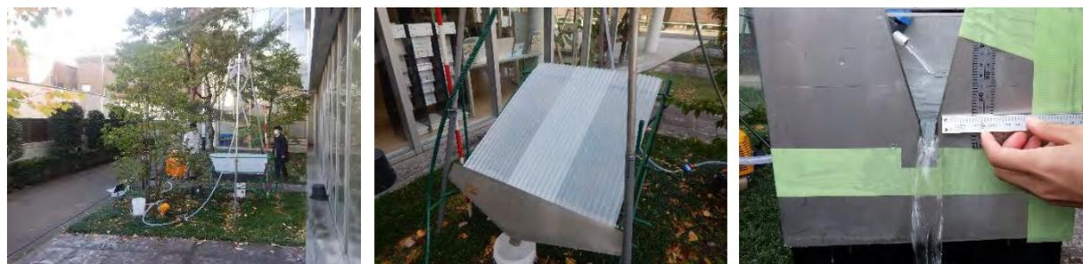
図 3.35 千代田区の緑地における人工降雨装置の調整と三角ノッチの流量実測
