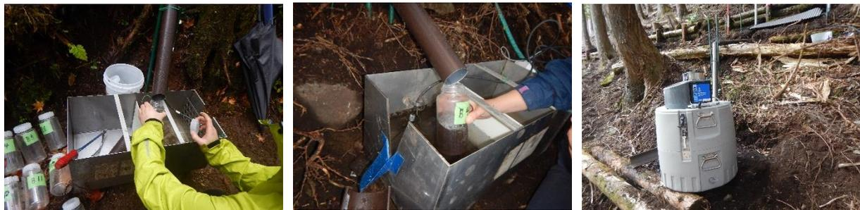
図 3.40 表面流の採水状況とオートサンブラ
