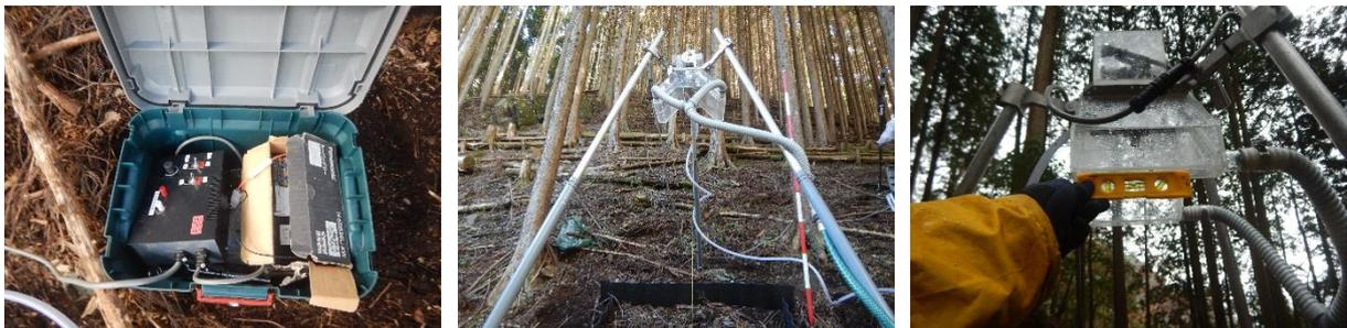
図 3.39 ノズル揺動用の電源や振幅制御パネルと人工降雨装置の設置
