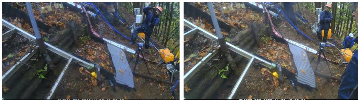
図 3.50 タイムラプスカメラによる散水開始直後と30分散布後の状況
