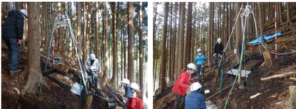
図 3.61 人工降雨試験実施状況
