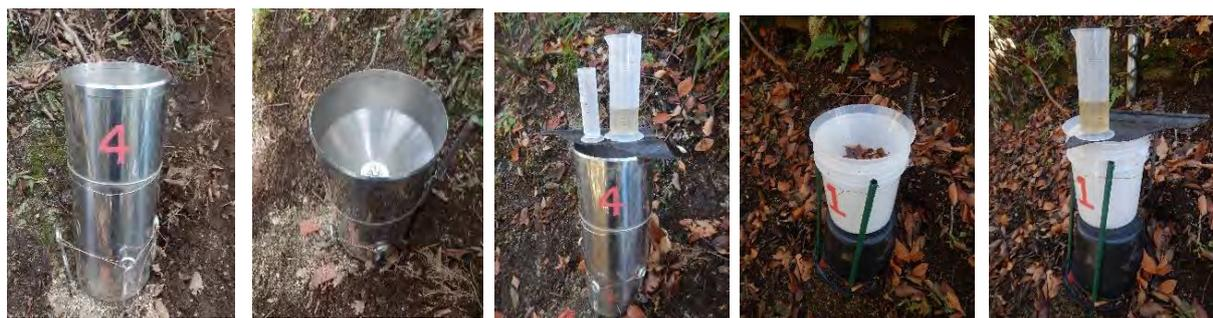
図 3.28 貯留型雨量計(気象庁制式と簡易式)の設置と捕捉量の計測状況
