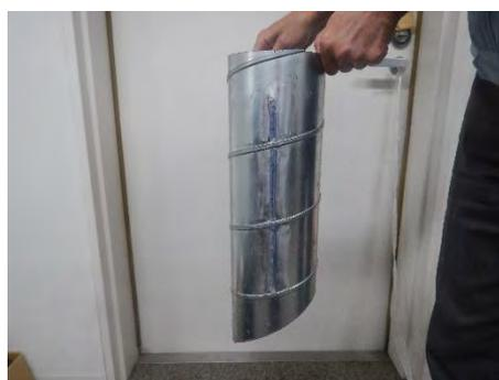
図 3.81 簡易冠水型浸透計
