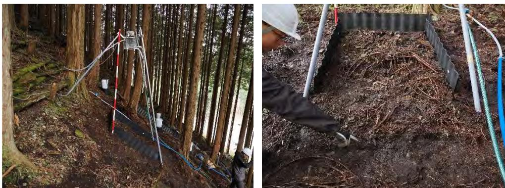
図 3.43 猪之頭 1 の筋工無における予備試験状況(左)及び表面流の発生状況(右)
