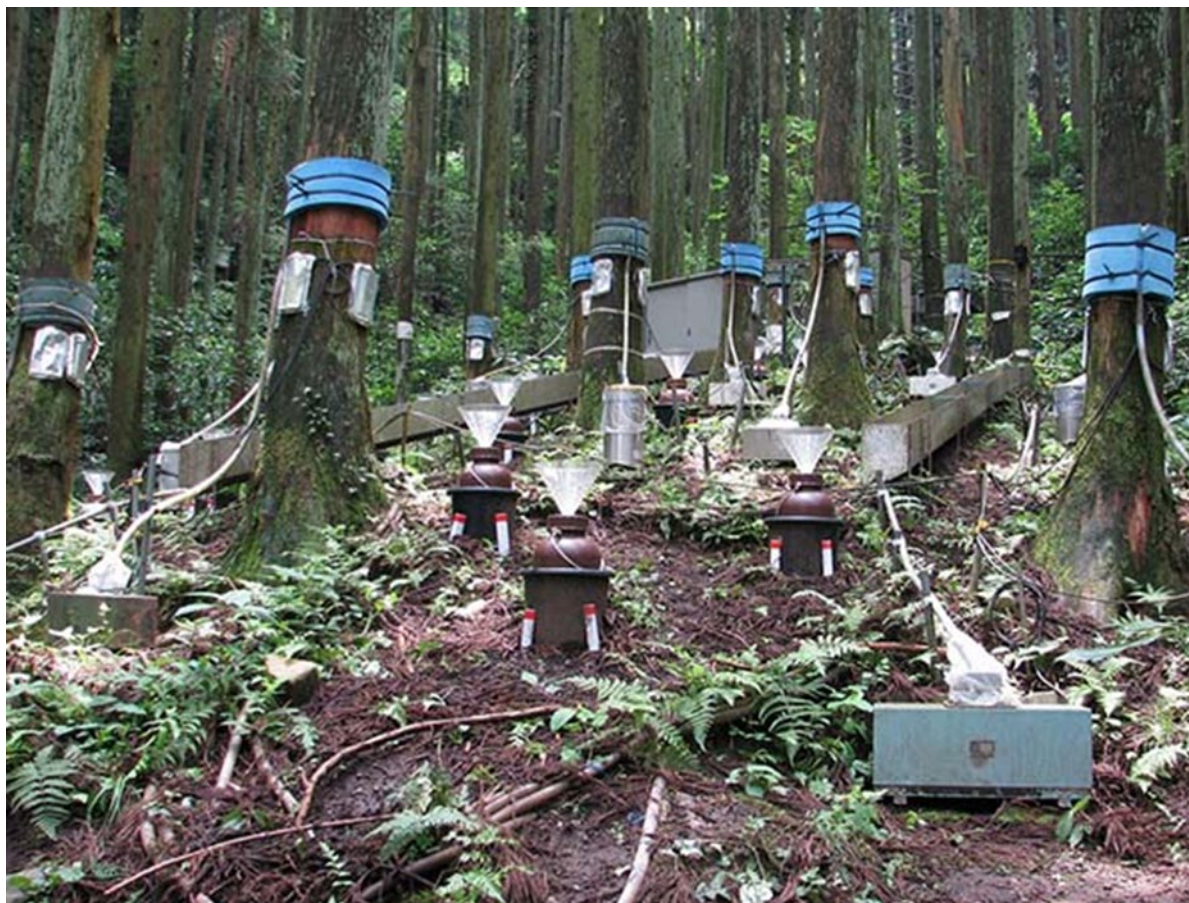
図 4-4 転倒ます型流量計の林内設置イメージ (Iida et al., 2017)
