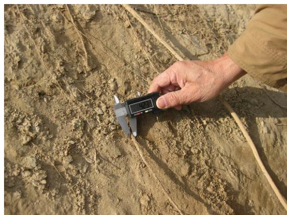
写真 1.4 根の径の計測
