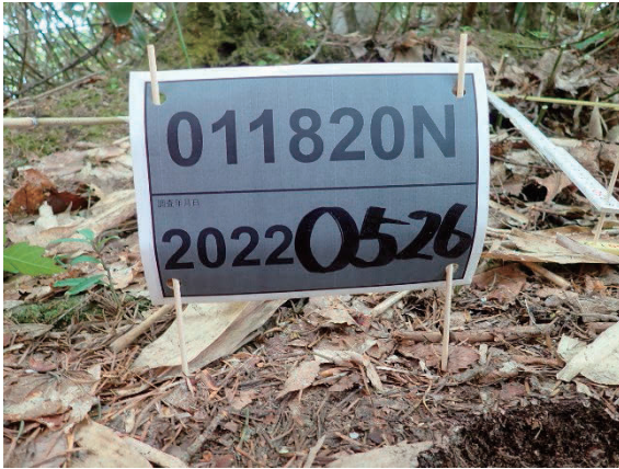
竹串を挿して角度を調整できるように工夫された撮影用ボード
