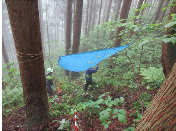
写真2 土壌調査地点を雨から保護するためにブルーシートを張った。
