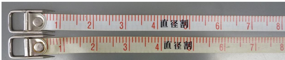
写真 3-3 直径割巻尺の伸び状況（上：新品、下：検証調査 1 年使用）
