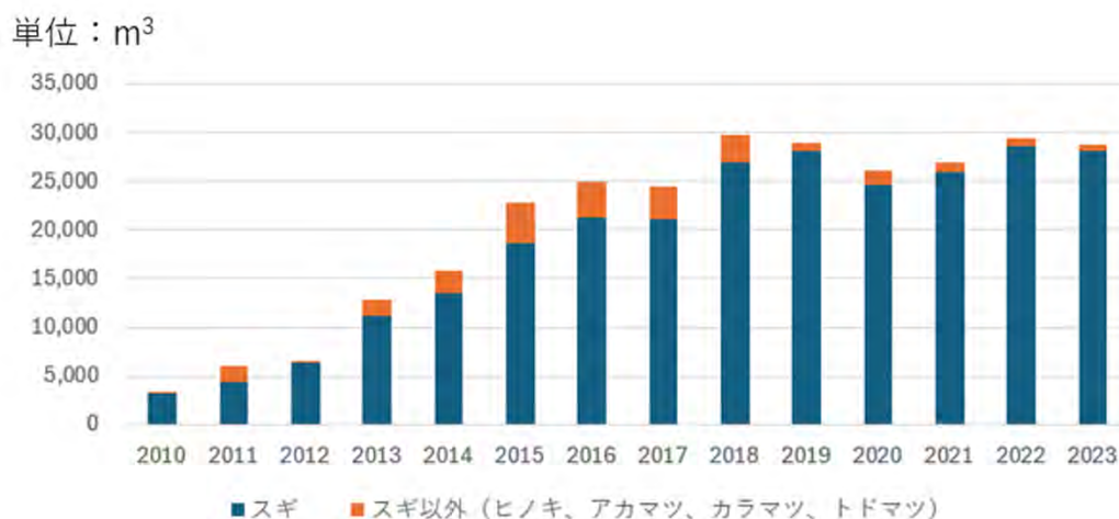
図3-5. 特定工法4工法の杭丸太打設量の推移
