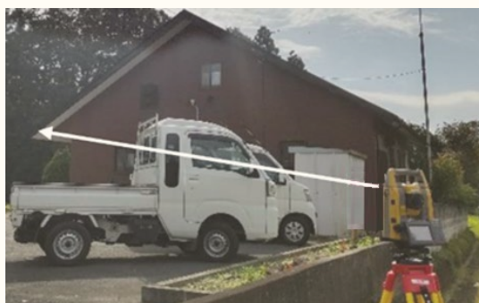
図 4-4 水平精度の検証（建物の測量）
