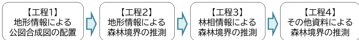
図 5-5 リモセンデータを用いた境界の推測の手順
