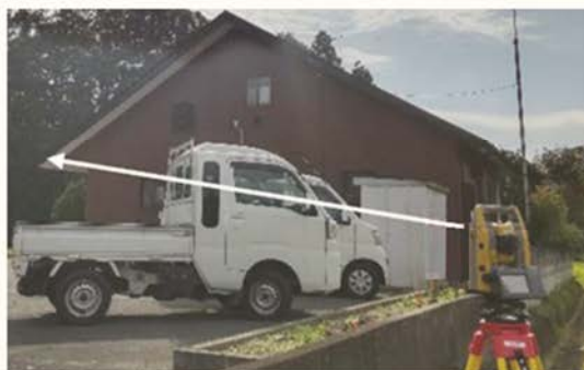
図 4-4 水平精度の検証（建物の測量）
