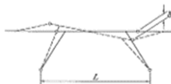
ラーメン橋のたわみ
