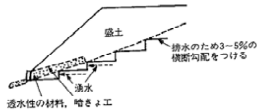
図 4-16 基礎部の排水処理例
