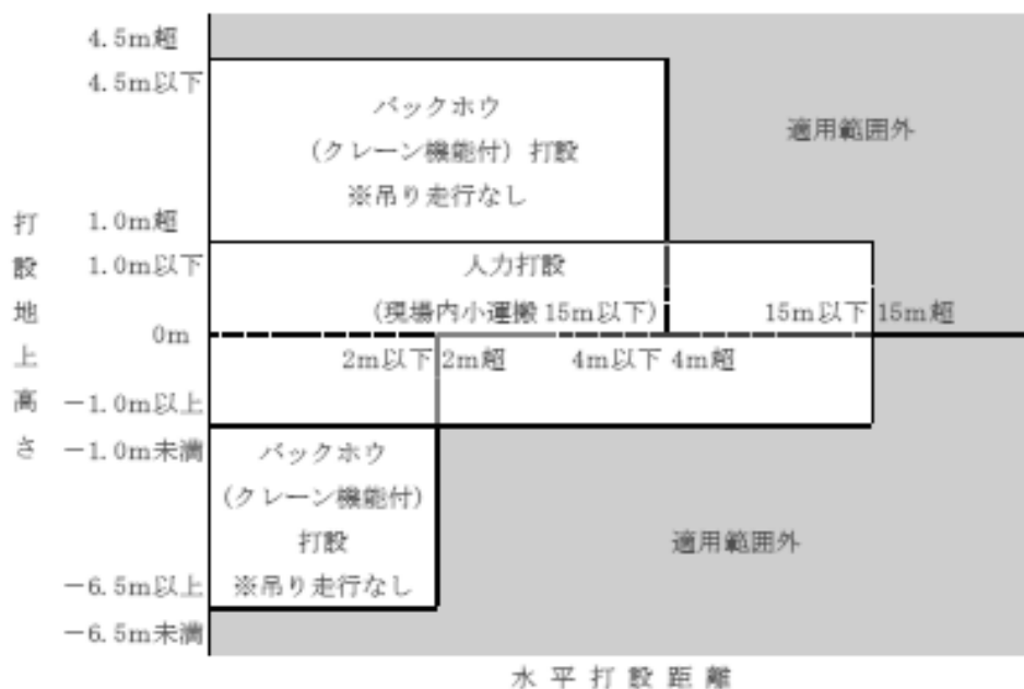
図3-1 コンクリート打設工法の選定
