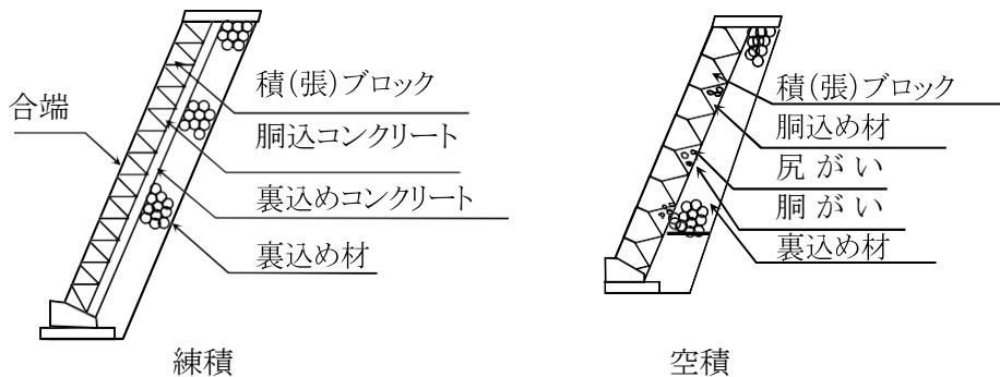
図3-4-4 コンクリートブロック工
