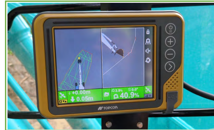
I C T建機による掘削時のモニター
