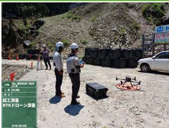
UAV写真測量状況
