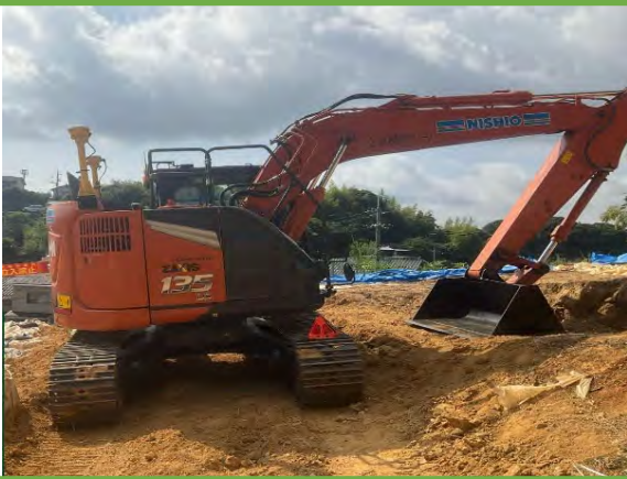
使用機械(MCバックホウ(0.45m 3 ))
