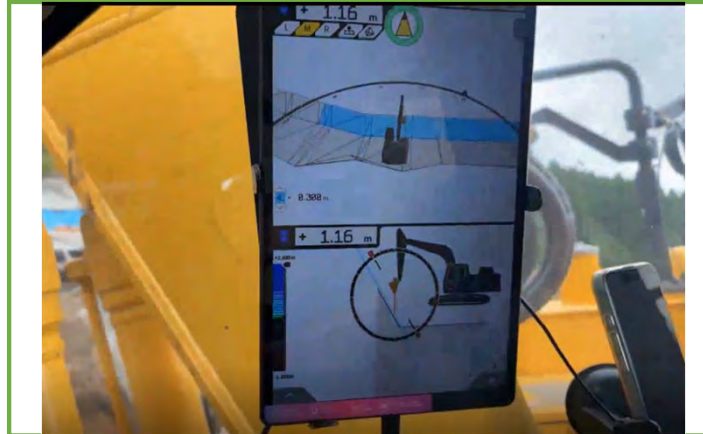
3D-MGバックホウ：キャビン内モニター表示
