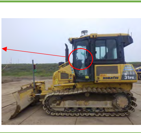
ICT建機：転圧管理システム(Geo-Press Cloud)
