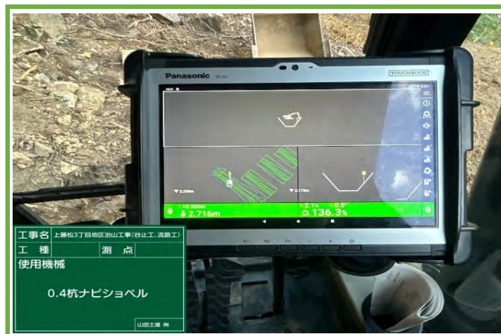
3次元データで高精度な掘削
