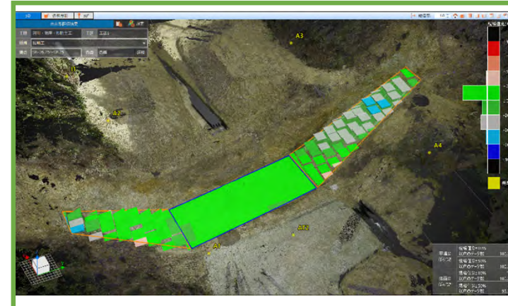
3次元データを用いた出来形管理
