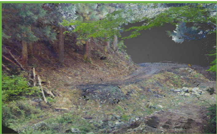
起工測量 スキャンデータ合成後
