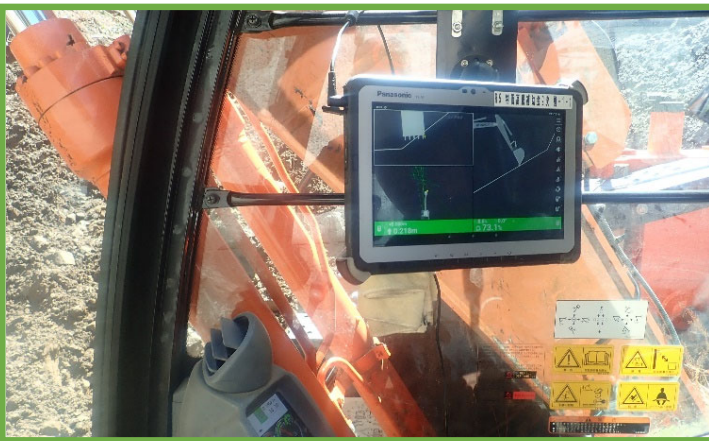
MGバックホウ モニター画面
