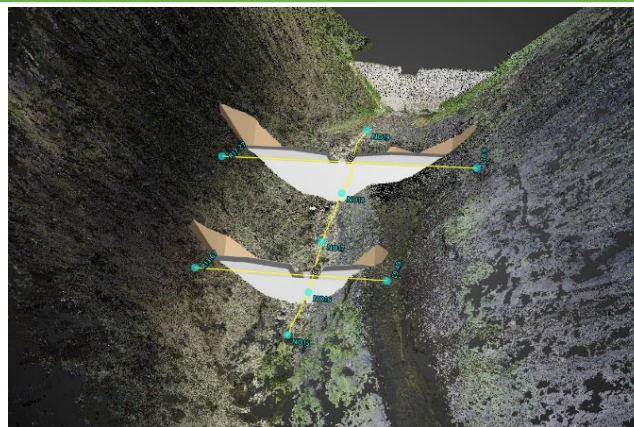
起工測量・3次元設計データ
