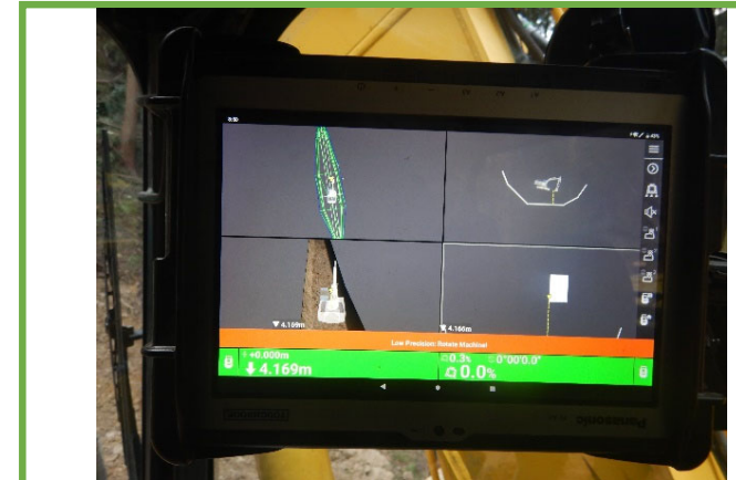
MGバックホウのモニター
