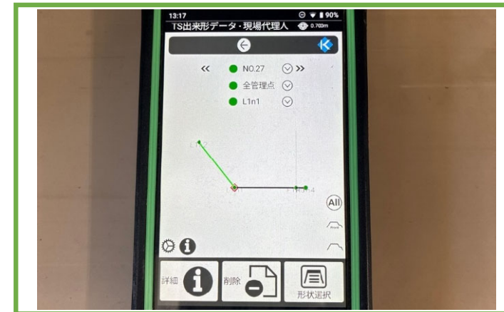
TS等光波方式を用いた出来形計測
