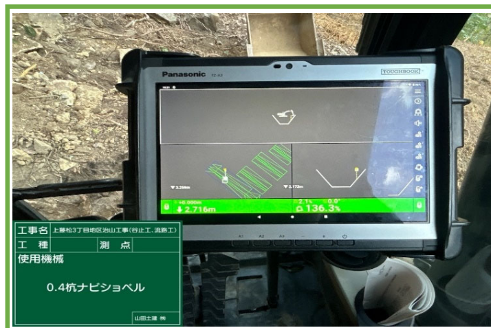
3次元データで高精度な掘削
