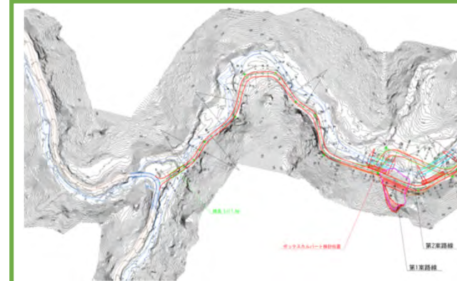
3D点群データによる平面図作成
