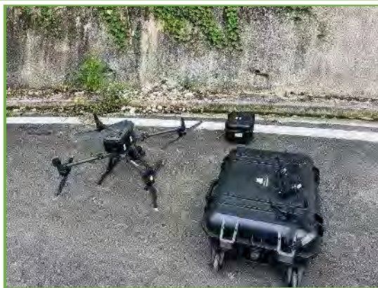
3次元起工測量に使用したドローン
