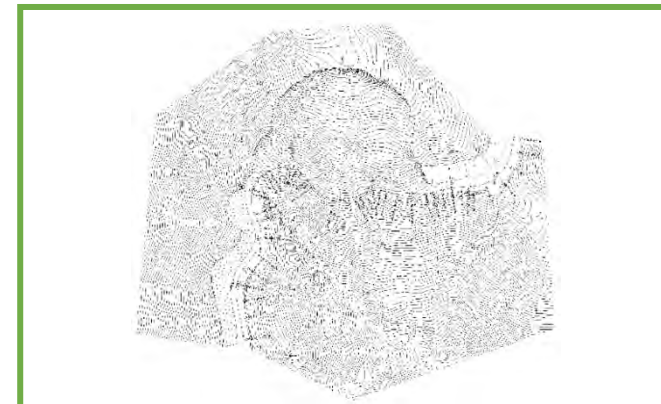
3D点群データによる平面図作成
