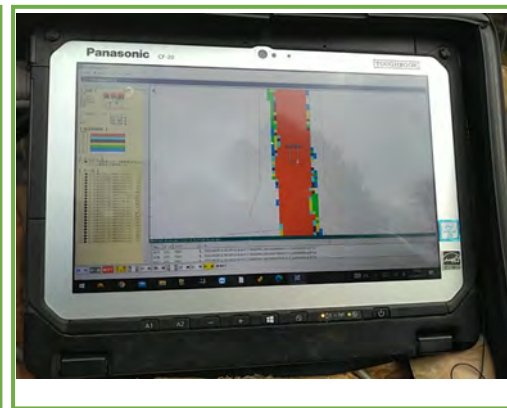
転圧回数確認タブレットモニター
