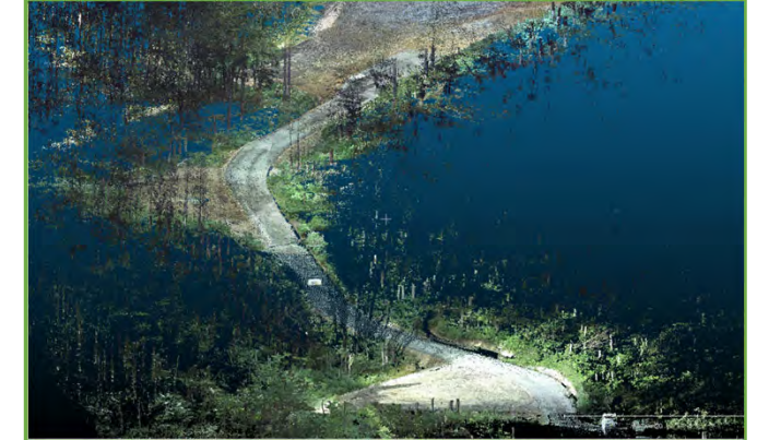
施工後の三次元点群データ
