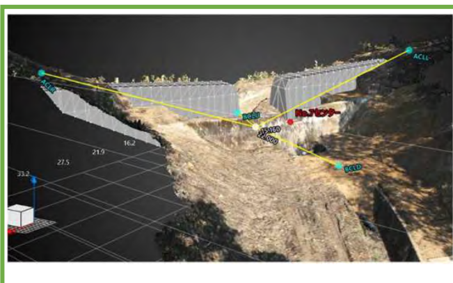
起工測量結果及び3次元設計データ
