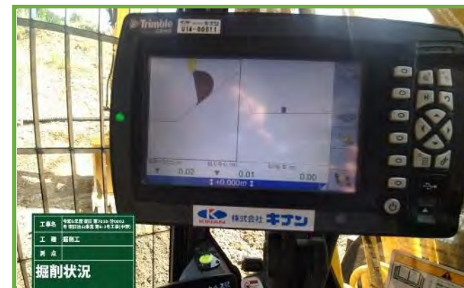
MGバックホウ タブレット画面
