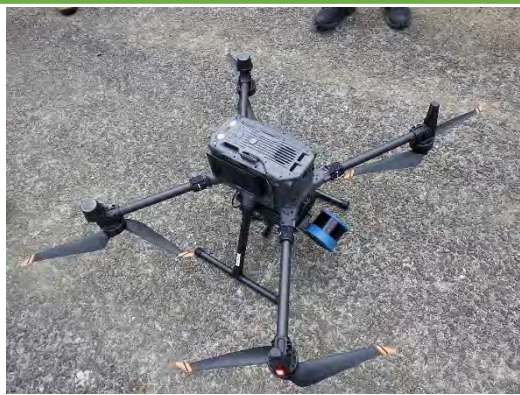
使用機械（Matrice350RTK, Hovermap ST-X）
