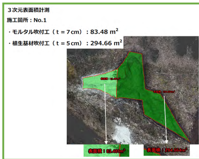
3次元施工面積計測
