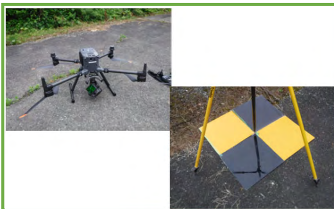
測量に使用したUAV機器等
