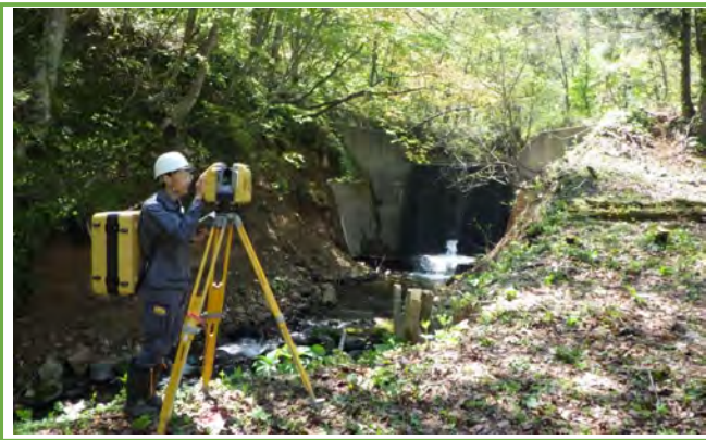
地上型LSによる起工測量
