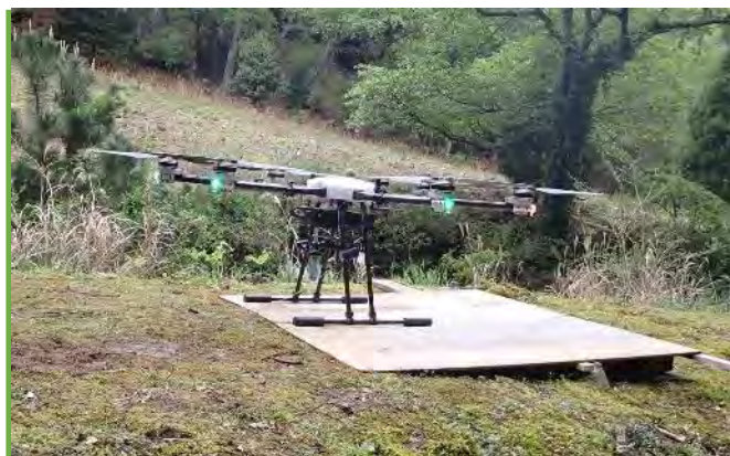
機体幅：約3m、最大搭載重量：25kg
