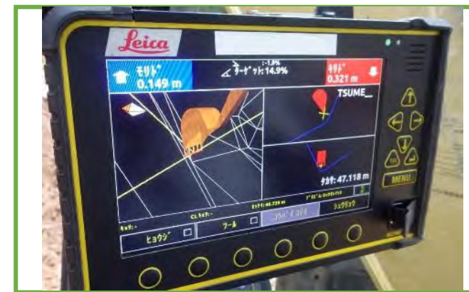
MGバックホウによる掘削
