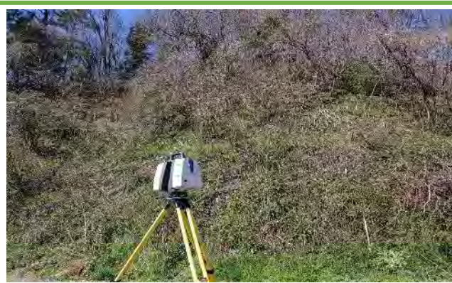
レーザースキャナーによる起工測量
