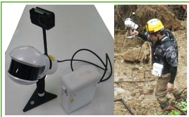
使用した手持ちLiDAR機器（LiDAR SLAM）と作業風景
