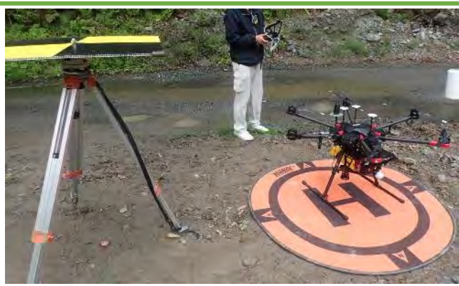
UAVによる3次元起工測量
