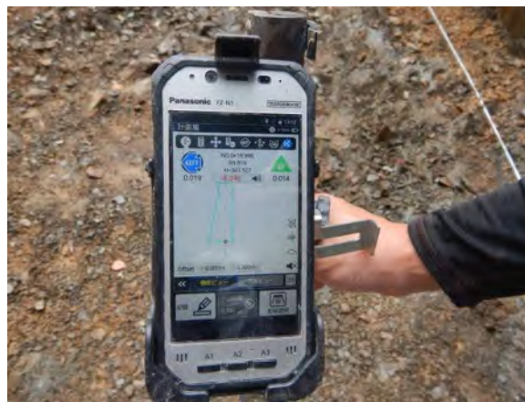
3次元データを基に床掘高を確認
