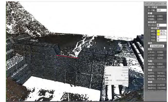
3次元データを用いた出来形管理
