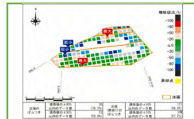
3次元出来形管理(掘削工の面管理)
