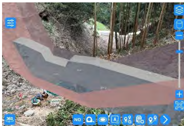
掘削面のARイメージ
