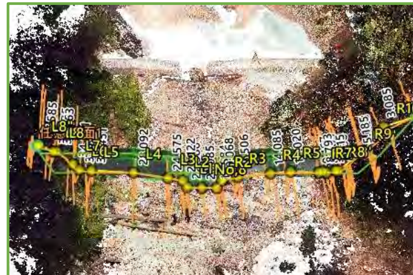
3次元起工測量データ
