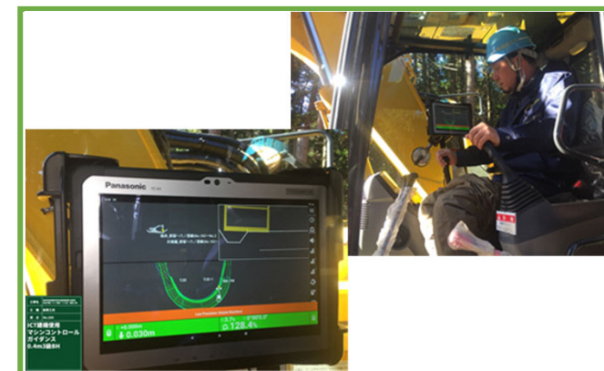
マシンコントロールガイダンスによる重機操作
