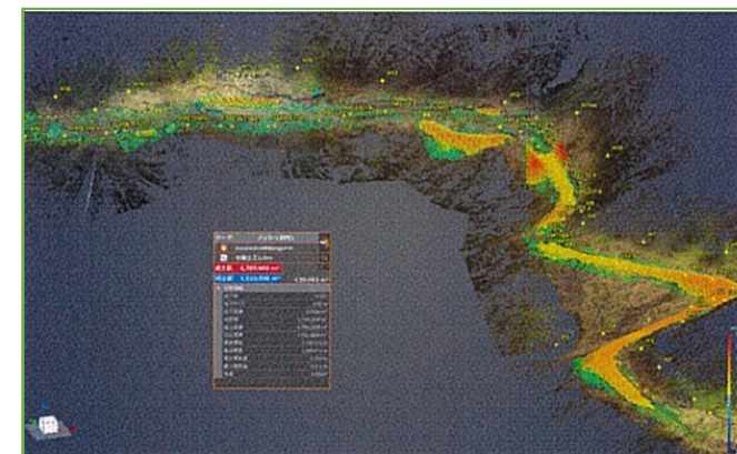
3Dデータによる土量比較
