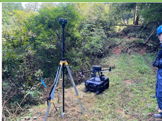
UAV測量作業状況
