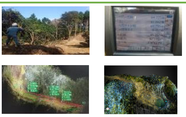
起工前測量で地上型レーザースキャンを活用し3次元データを作成。
