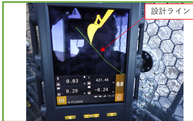
MGバックホウ操縦者確認モニター 設計ラインと爪先の差が図と数値で表示される
