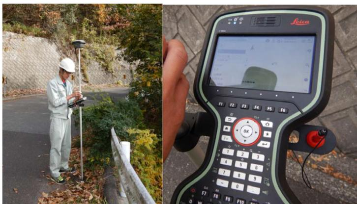
写真 3-1 RTK-GNSS測位器による観測状況
