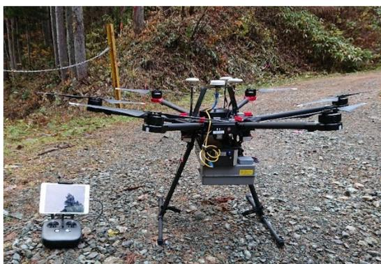
写真 3-2 UAVレーザ測量に用いる機体
