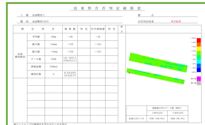
ヒートマップによる出来形管理
