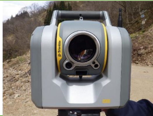
山腹面全体の測量する3Dレーザー scanner (ニコン: Trimble X10)
