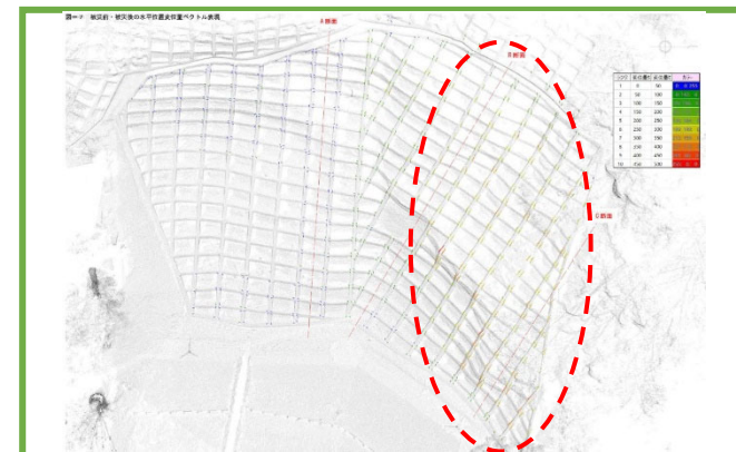
目視では判別が難しい 構造物の変位（被災範囲）を特定
