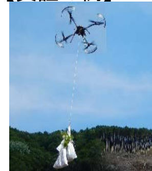
ドローン苗木運搬
