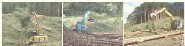
図3 機械による地拵えの事例 52
