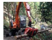
<材の枝払い、玉切り等を連続して行う高性能林業機械>
