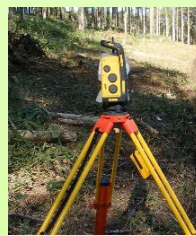
自動追尾型トータルステーションを利用した起工測量
