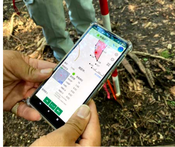
申請時GNSS計測結果の再現 (山林測量ソフト山守GPS)
