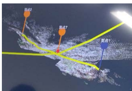
点群データによる地山勾配の確認
