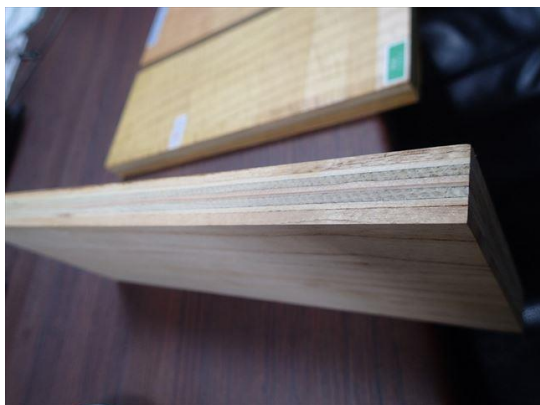
スギ (12mm) をセンダン (4mm) で挟んだ PLT
