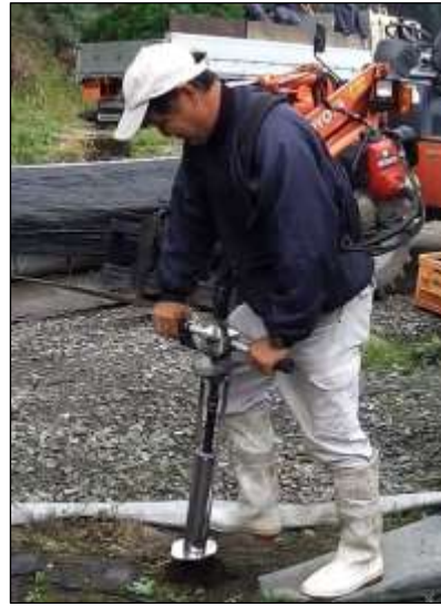
(左) 小型掘削機（アースオーガー）によるコンテナ苗の植穴掘削例（北海道千歳町におけるエンジンオーガー使用例）
