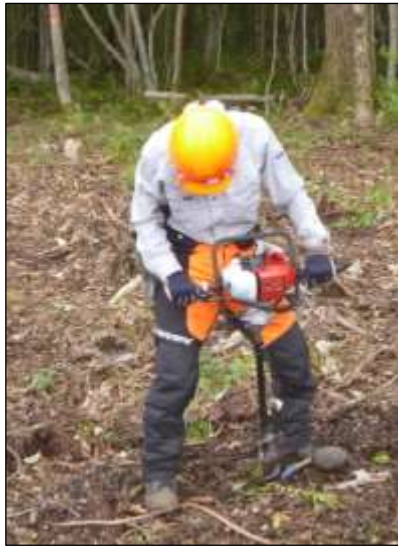
(左) 小型掘削機（アースオーガー）によるコンテナ苗の植穴掘削例（北海道千歳町におけるエンジンオーガー使用例）
