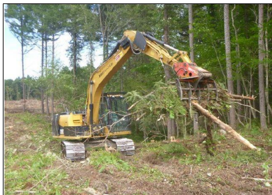
北海道石狩地域のカラマツ林の伐採作業 (グラップルレーキによる地拵え事例)
