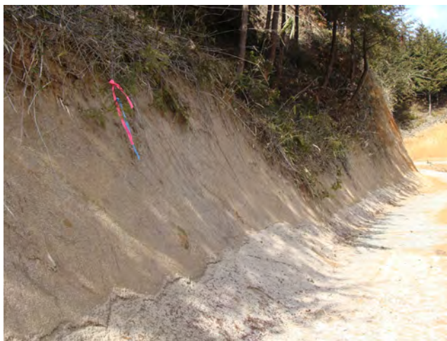
写真 6-7 H2 試料採取箇所 (H21 開設路線 まさ土)
