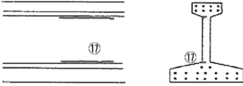
⑰ PC鋼材が集中している付近のひびわれ
