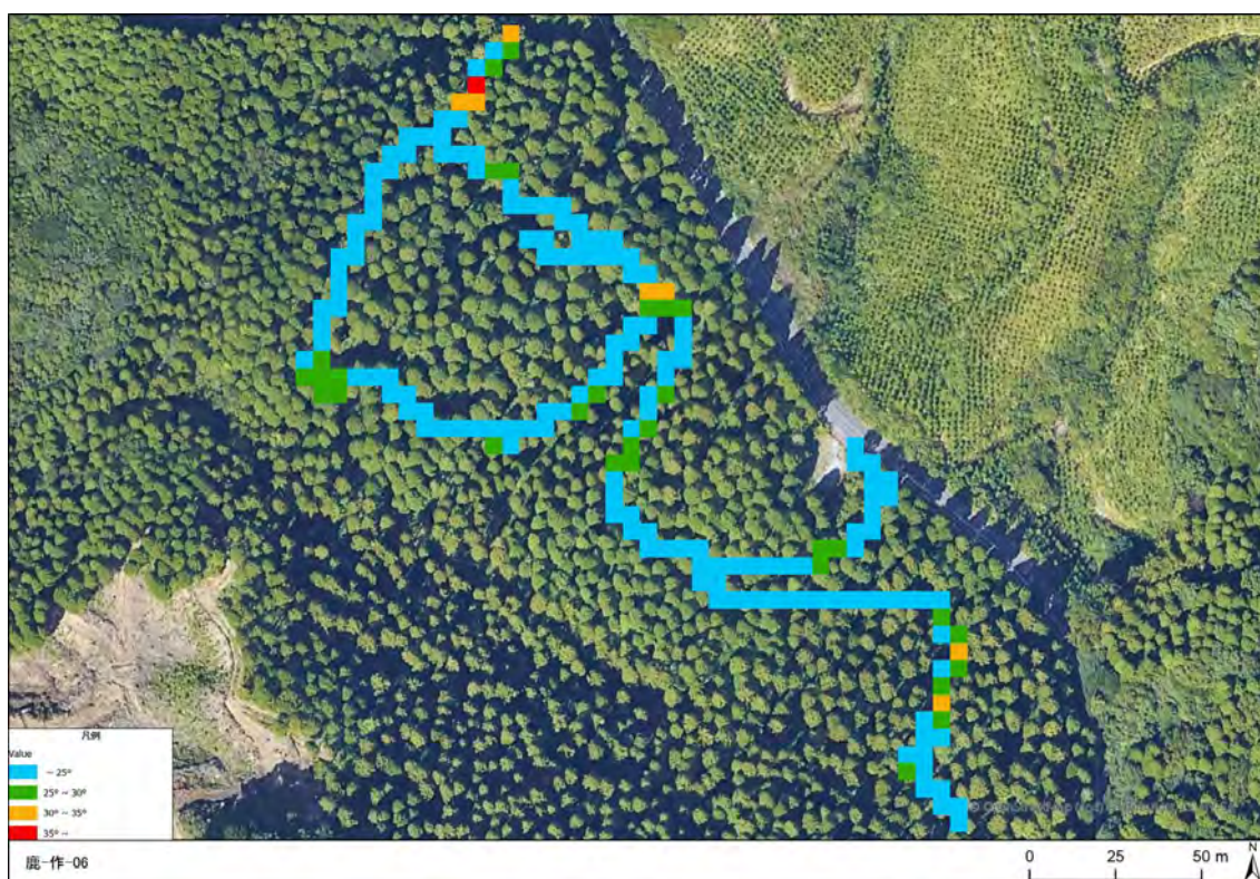
図 2.1-315 調査延長の地山傾斜
