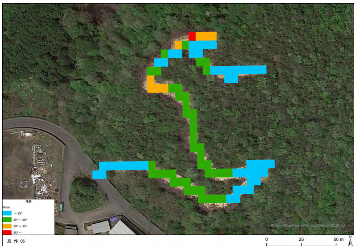
図 2.1-153 調査延長の地山傾斜
