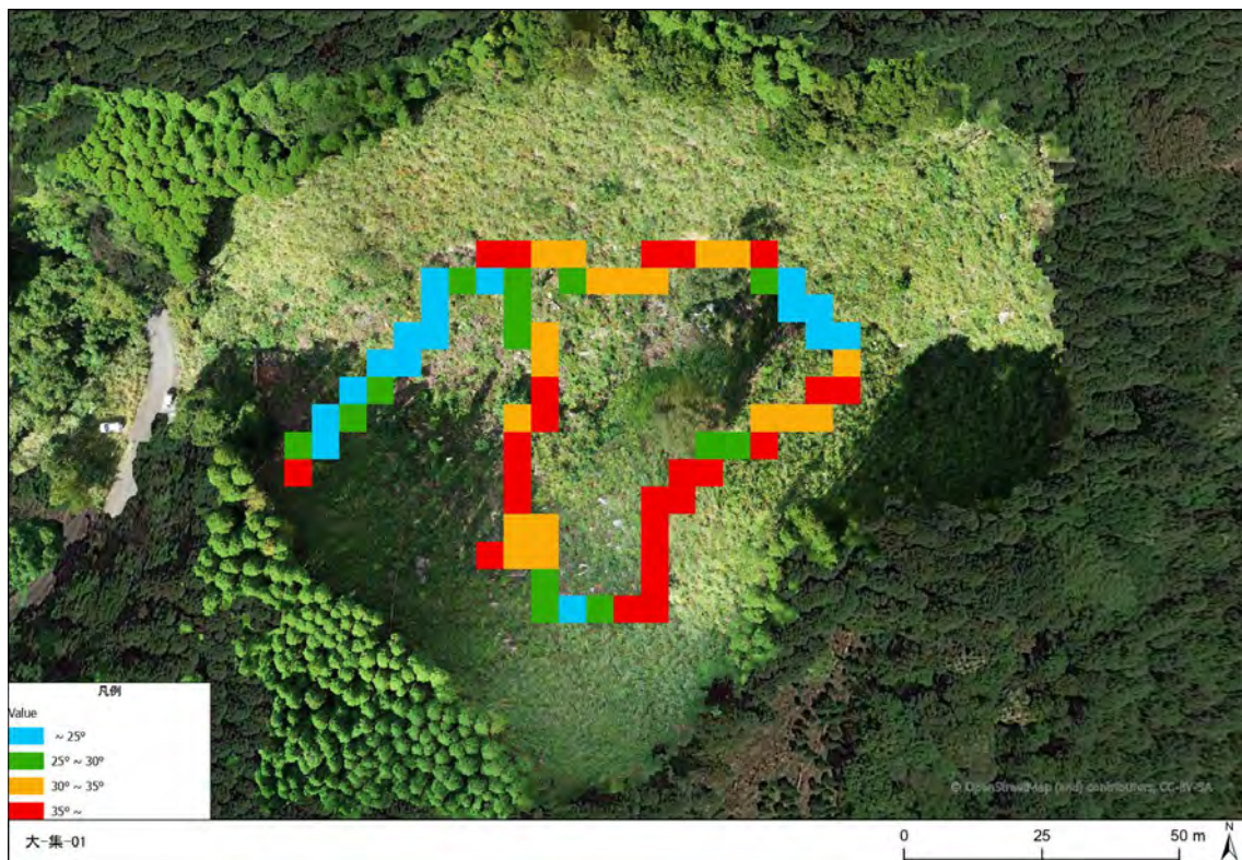
図 2.1-274 調査延長の地山傾斜
