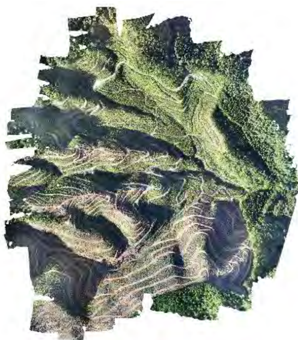
図 2.1-7 UAV空撮画像から作成した集材路の点群データ
