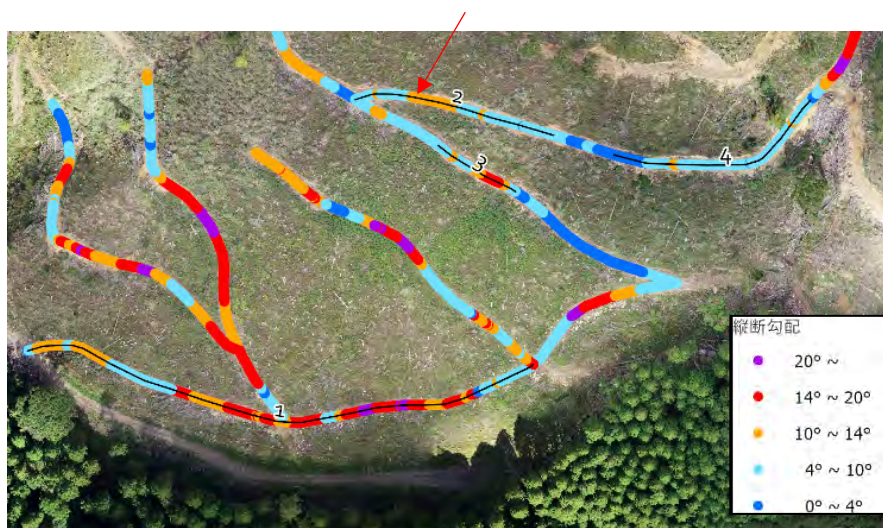
図 2.2-34 縦断勾配の計算値（5色に区分）と路面洗掘区間（黒ライン）
