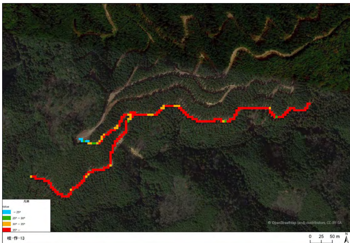
図 2.1-120 調査延長の地山傾斜
