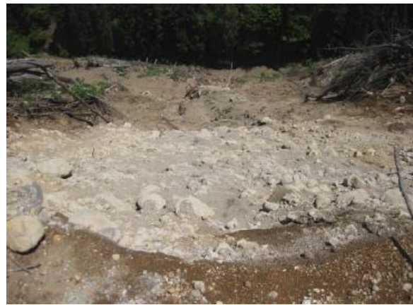
写真-2.29 崩壊発生源 (上部から下部層を望む) 基岩が露出してお り、これが不透水層となり、崩壊発生した ものと考えられる。
