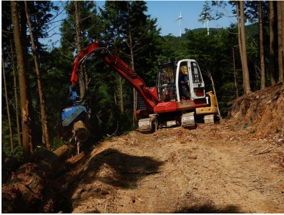
写真-3.9 スイングヤーダによる集材
