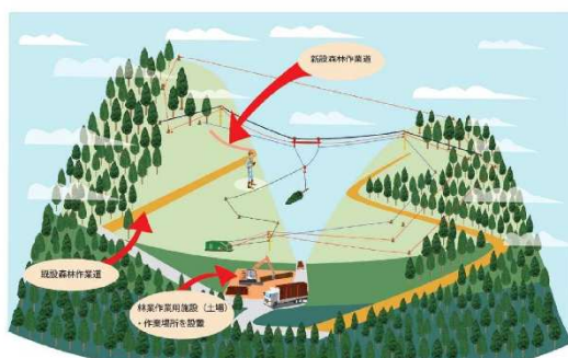
林内路網と連携したエンドレスタワー方式による架線系集材 (概略図)
