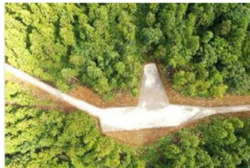
改築により十分な幅員の車回しを確保した林道
