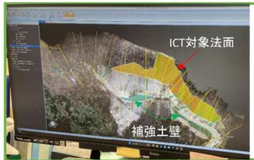
UAV空中写真測量による3次元データ
