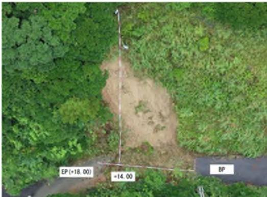
写真 3.2.45 法面崩壊状況（被災当時）
