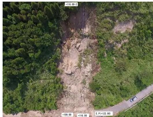
写真 3.2.42 法面崩壊状況(2) (被災当時)
