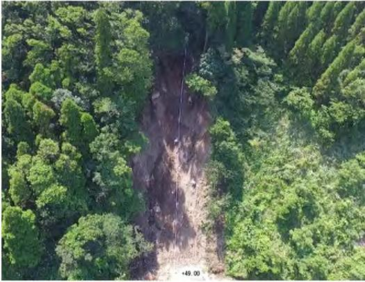
写真 3.2.41 法面崩壊状況(1) (被災当時)
