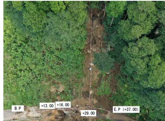
写真 3.2.38 法面崩壊状況(被災当時)
