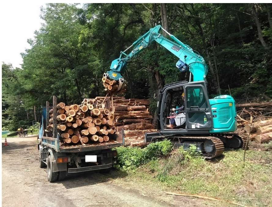
固定式グラップルによる 2t ダンプからの積下
