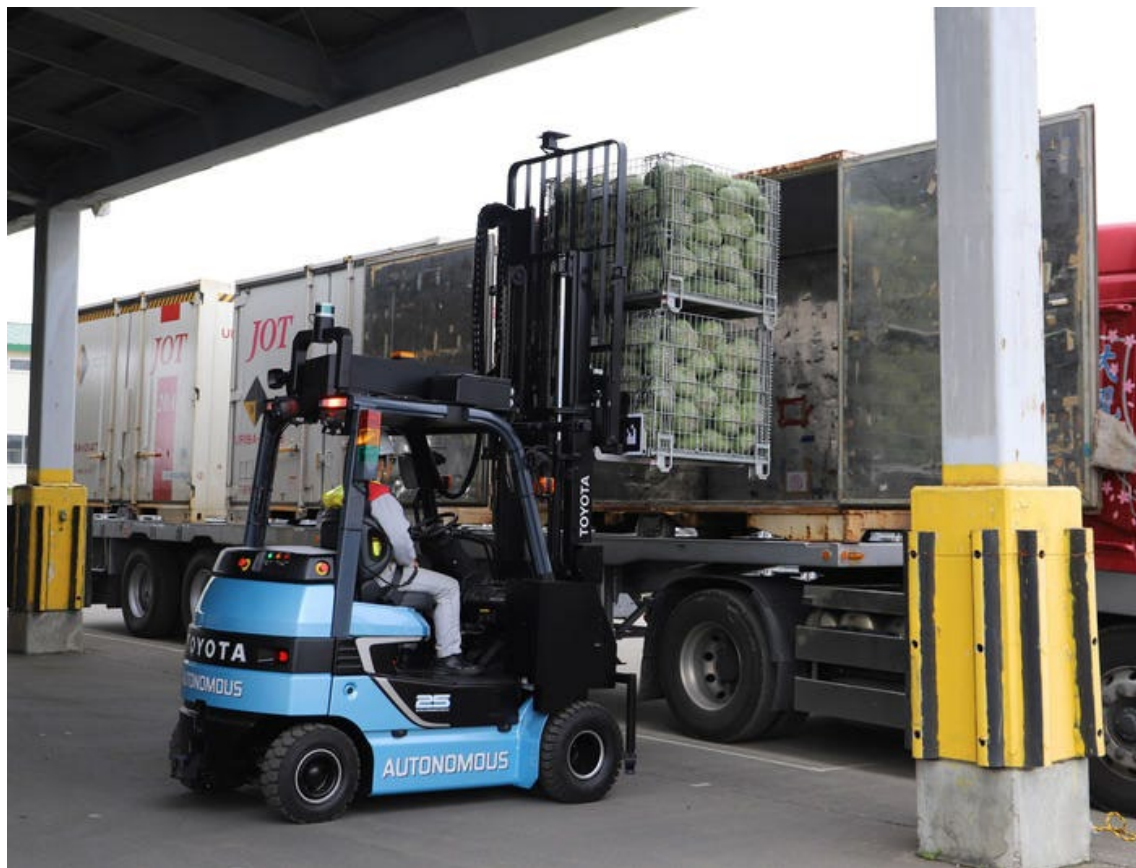
自動運転フォークリフトによる荷積み
