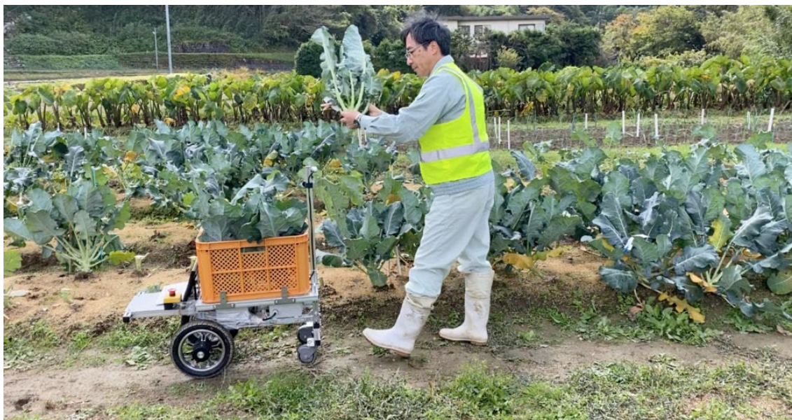
人追従型収穫物搬送ロボットによる収穫物搬送
