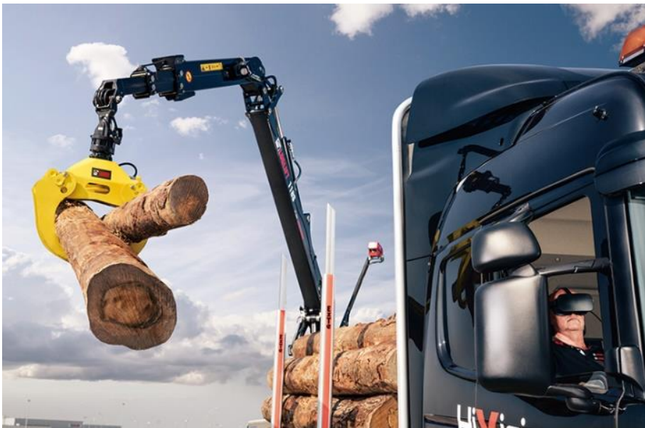
車動するクレーンをトラックキャビンの助手席から操作する。トラックから出ることなく原木の積み込みが完了する。
