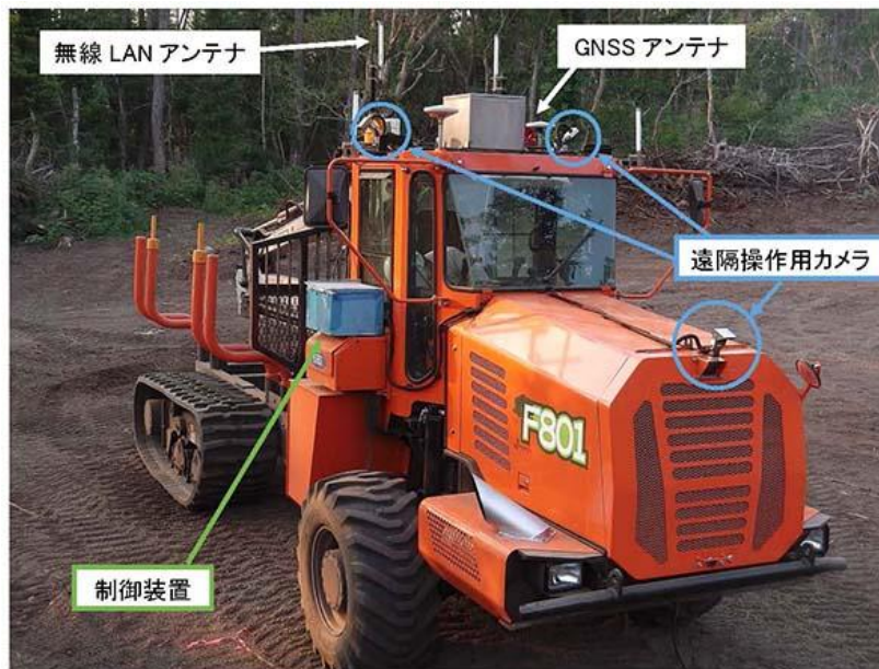
写真：遠隔操作と自動走行機能が付加されたフォワーダ
