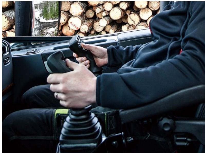
積み込み作業時は、ジョイスティック型のコントロールで直感的なオペレーションが可能。
